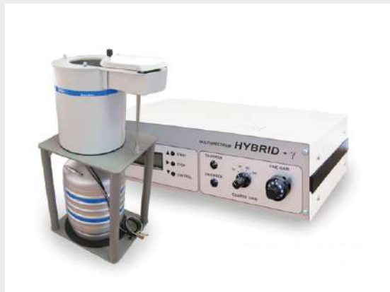
감마선분광분석기 HPGe spectrometer
